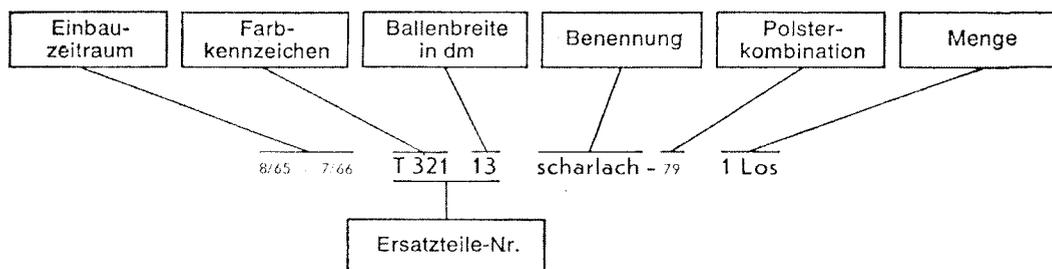
Für Loswaren, die ab 1. 8. 1966 neu freigegeben wurden bzw. weiter in Serie sind, ändert sich die Ersatzteile-Nr. Die Ballenbreite ist in cm in der 7. bis 9. Stelle der Ersatzteile-Nr. angegeben.
